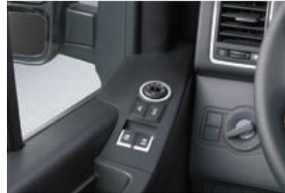
Elektrische Fensterheber und elektrisch einstellbare Außenspiegel
