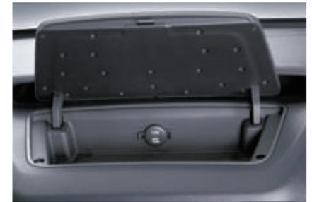
Zentrales Ablagefach mit 12V-Anschluss
